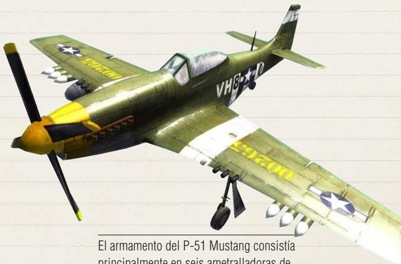
El armamento del P-51 Mustang consistía principalmente en seis ametralladoras de calibre .50 montadas en las alas. Para las misiones de ataque a tierra, era equipado con dos bombas de 907 Kg y hasta 10 cohetes de 127 mm.
